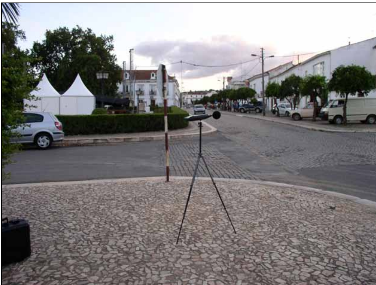
Figura 4-1 – Exemplo de uma medição realizada com o sonómetro a uma via rodoviária.
