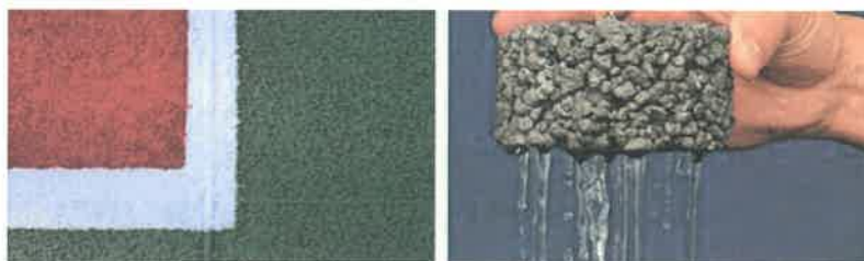
Fig. 11 –Exemplo de betão poroso do 4po paviston em várias cores e demonstração de permeabilidade.
